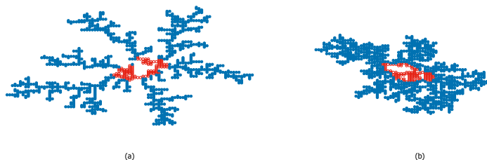
Рис. 4.29.1: Процес DLA (частинки показані синіми символами) на полімерному флокулянті (червоні символи) з ймовірностями адсорбції p = 1.0 (a) та p = 0.1 (b).
